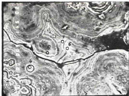
Obr. 4. Kompozícia s vyznačenými miestami bodových kvantitatívnych analýz, vz. 5381a, tab. 1
